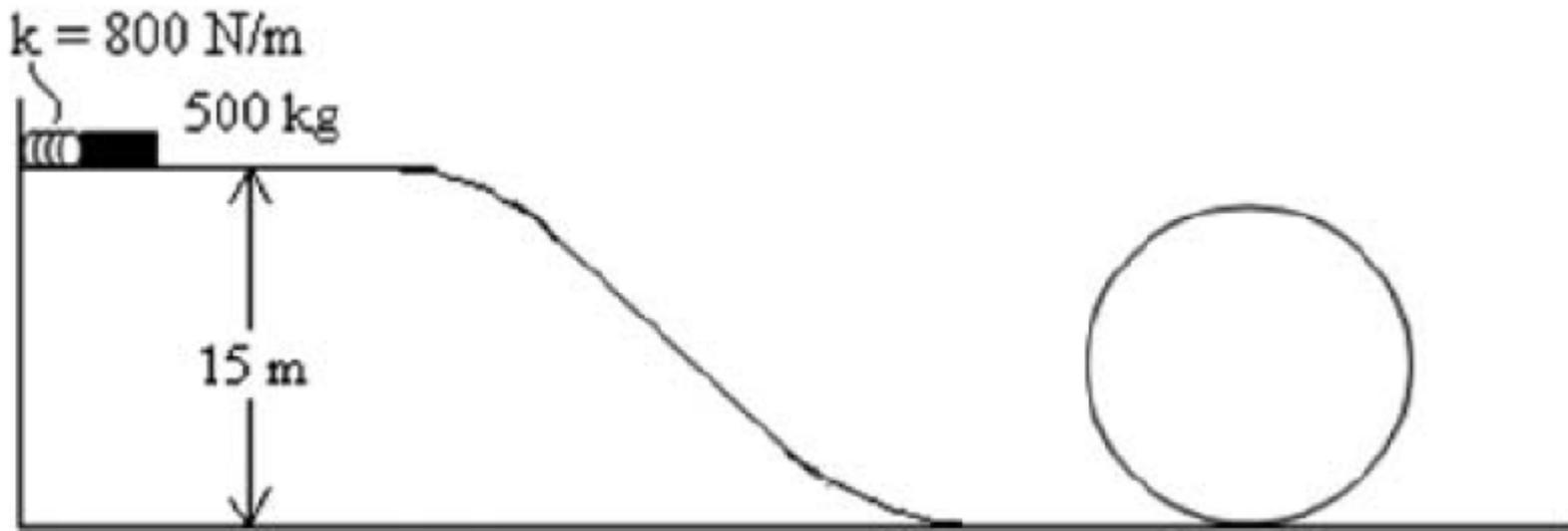
Supondo agora que há atrito entre o carro as calhas (com coeficiente  $0.20$ ), qual é a velocidade do carro quando acaba a extensão da mola?
